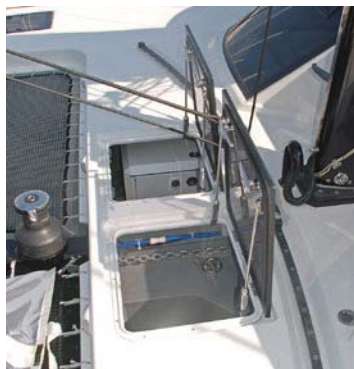
ESTIBA Y ORDEN La optimización de la estiba es una condición en un crucero de altura. Aquí, dos cofres frente al carro del foque autovirante la aseguran.
