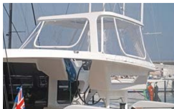
PROTECCIÓN TOTAL El techo rígido de carbono que puede cerrarse totalmente ofrece un excelente resguardo al timonel.
