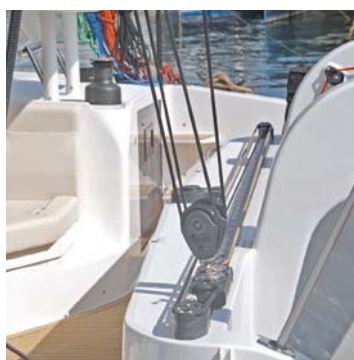
FÁCIL CONTROL DE MAYOR El carril de escota de mayor, que se controla desde el puesto de gobierno, se ha situado en popa sobre la brazola del espejo.
