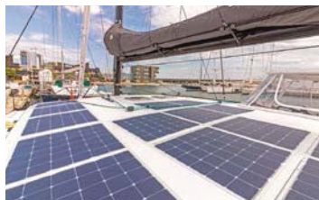
ENERGÍA INAGOTABLE La gran superficie libre del tejadillo de la caseta permite instalar placas fotovoltaicas.
